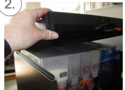
2. Nun können Sie den Gerätedeckel nach oben öffnen. Entnehmen Sie die Dokumentenmappe. Diese beinhaltet eine Bedienungsanleitung, Schaltplanlegende, Produktschilder und eine Checkliste. Entnehmen Sie die Kartonbox mit dem Netzkabel und Gerätefüße. Bringen Sie die Gerätefüße an.
