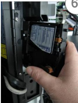
6. Entnehmen Sie den Münzprüfer aus dem KIT. Der Münzprüfer wird in die Halterung einfach eingeklippt. Prüfen Sie mit dem Münzrückgabeknopf, ob die Funktion gewährleistet ist.
