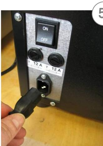
5. Entnehmen Sie das Netzkabel im Inneren des Gerätes und stecken Sie es zuerst hinten im Netzmodul des Gerätes ein und danach in der Steckdose. Achten Sie darauf, dass der Netzschalter auf „0“ steht. **Schalten Sie das Gerät noch nicht ein.**
