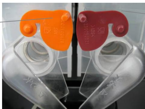
Erhöhte Produktrutsche mit dunkelrotem Verschluss. Wird meistens für Kakao eingesetzt, da dieser mehr rieselfähiger ist.
