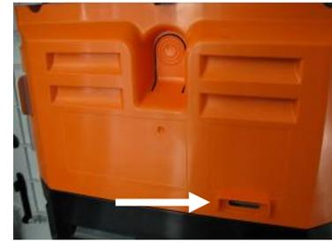
Der FlashCard Slot befindet sich an der inneren Orangen Türabdeckung.
