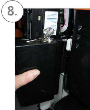
8. Nehmen Sie die Geldkasse, öffnen Sie mit dem Schlüssel die Kasse. Sie können die Kasse nur ein- und ausbauen, wenn sie mit dem Schlüssel geöffnet ist. Die Verriegelung des Schlosses hakt in der Kassenhalterung ein. Schließen Sie die Kasse und entnehmen Sie den Schlüssel.
