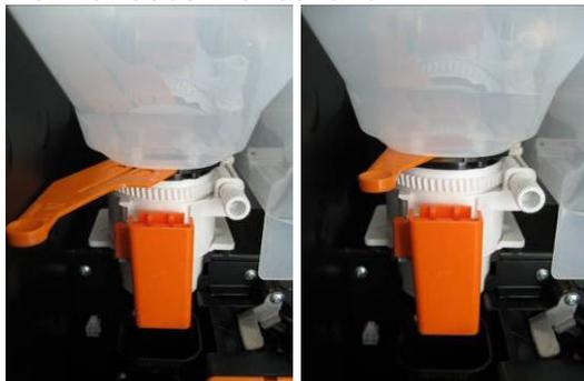
Schieber geöffnet Schieber geschlossen
