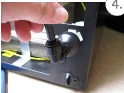
4. Stecken Sie den schwarzen PE-Schlauch in den John-Guest-Verbinder fest ein. Sichern Sie diesen mit dem roten Sicherungsring. Schließen Sie das andere Ende am Wasserfilterkopf an. Falls kein Wasserfilter benötigt wird, am Eckventil. Öffnen Sie die Wasserzufuhr am Eckventil und überprüfen Sie die Anschlüsse auf
