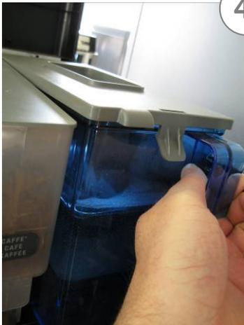
4. Entnehmen Sie den Wassertank aus dem Gerät. Entnehmen Sie die Tank in Tank Filterkartusche aus der Verpackung und legen Sie diese zuerst ein paar Minuten ins Wasser, bevor Sie die Kartusche im Gerät benutzen. Setzen Sie danach den Tank in Tank Einsatz und die Kartusche ein und befüllen Sie den Wassertank Randvoll zur Erstinstallation.
