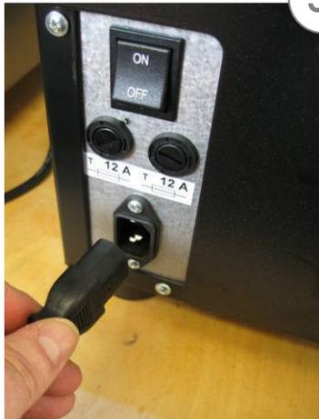
3. Entnehmen Sie das Netzkabel im Inneren des Gerätes und stecken Sie es zuerst hinten im Netzmodul des Gerätes ein und danach in der Steckdose. Achten Sie darauf, dass der Netzschalter auf „0“ steht. **Schalten Sie das Gerät noch nicht ein.**
