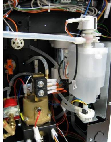
Ausgleichsbehälter, Flowmeter und Einlassventil für die Wassertankversion
