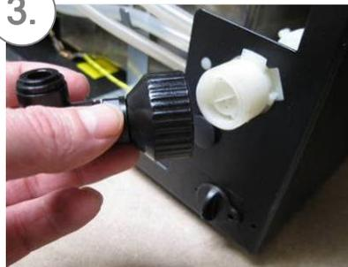
3. Entnehmen Sie den Wasseranschluss - Kit. Öffnen Sie die Rückwand, damit Sie später prüfen können, ob im Gerät alles in Ordnung und Dicht ist. Drehen Sie die John-Guest-Reduzierung mit dem Winkel auf das Einlassventil. Ziehen Sie diesen fest mit der Hand an.
