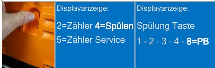
Drücken Sie die Programmtaste. Drücken Sie die Taste 4 für Spülen. Stellen Sie ein größeres Gefäß unter den Auslauf und drücken Sie die Taste 8 für das Brüh Reinigungsprogramm. Folgen Sie den Anweisungen im Display bis hier:
