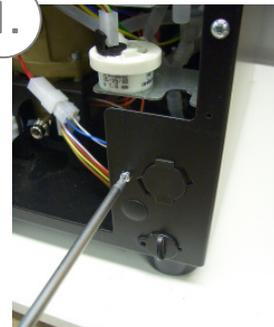
1. Öffnen Sie die Rückwand des Gerätes und entfernen Sie die Abdeckung für das Einlassventil.
