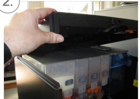
2. Nun können Sie den Gehäusedeckel nach oben öffnen. Entnehmen Sie die Dokumentenmappe. Diese beinhaltet eine Bedienungsanleitung, Schaltplanlegende, Produktschilder und eine Checkliste. Entnehmen Sie die Kartonbox mit dem Netzkabel und Gerätefüße. Bringen Sie die Gerätefüße an.
