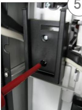
5. Für die Kabelverbindungen unterhalb des Münzprüfers an der Tür innen sind mit einer Halterung versehen. Entfernen Sie diese und befestigen Sie hierfür die im KIT mitgelieferte Halterung für die Kasse mit den Schrauben die Sie abgeschraubt haben.
