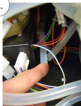
5. Stecken Sie mitgelieferten kürzeren Schlauch auf dieses T-Stück auf und stecken Sie das mitgelieferte T-Stück auf diesen Schlauch. Anschließend den Schlauch vom Ausgleichsbehälter ebenfalls auf das T-Stück stecken.
