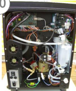
10. Rückseite des Gerätes mit eingebautem Festwasserkit. Schließen Sie die hintere Gehäuseseite mit der Rückwand. Prüfen Sie die Schläuche auf korrekten Sitz. Achten Sie darauf das die Schläuche keine Knicke aufweisen. Kontrollieren Sie beim Einbau den Ausgleichsbehälter des Gerätes auf eine Kunststoffkappe. Wenn vorhanden diese bitte vor dem Einschalten der Maschine **entfernen**.
