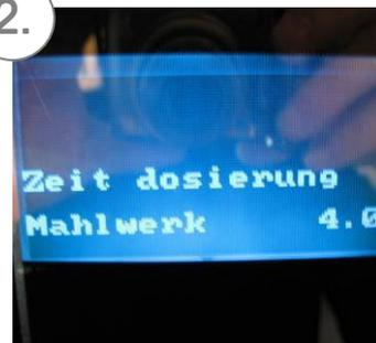
2. Drücken Sie nun die Programmtaste und wählen Sie im Menü 1=Programmierung, geben Sie den CODE ein. Wählen Sie sich vor bis zur Programmierung Taste Kaffee schwarz. Nun gehen Sie zum Einstellpunkt: Zeit Dosierung Mahlwerk. Optimaler Wert des Parameters ist 4,0 Sekunden.
