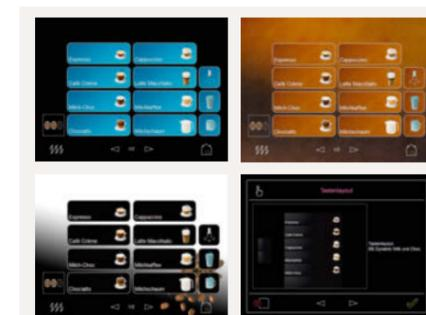
Es ist möglich, Tastenlayouts mit unterschiedlicher Tastenanordnung und Tastenanzahl, anderen Farben, Hintergründen und Transparenzen zu verwenden. So kann man z. B. im SB-Bereich ein „einreihiges SB-Layout“ wählen. Auch eigene Getränkebilder, Hintergründe oder Tastenlayouts können hochgeladen und eingesetzt werden.
