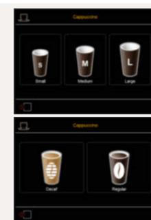
Im SB-Bereich besteht über die Funktion „PostSelection“ die Möglichkeit, Getränkeoptionen menügeführt beim Gast abzufragen. Der Gast wird Schritt für Schritt durch die einzelnen Getränkeoptionen geführt (Gefäßgröße, mit oder ohne Koffein usw.) und im Anschluss wird sein Wunschgetränk vollautomatisch zubereitet. Alle Optionen können selbstverständlich getränkesspezifisch frei festgelegt werden.
