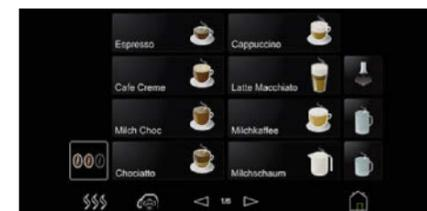
Acht Getränketasten auf sechs Ebenen ermöglichen das Einprogrammieren von bis zu 48 Getränken in Einzel- oder Doppeltassen. Auch Rezepte und Bilder sind hinterlegbar.
